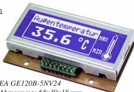
EA GE120-5NV24 Abmessung: 68x39x16 mm
